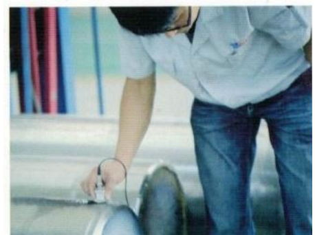
超声波探伤 Ultrasonic Inspection
